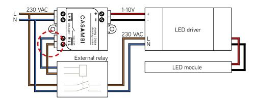
**ATTENTION :** Ne jamais brancher l'alimentation 230Vac du driver sur la sortie du CBU-ASD. La sortie du CBU-ASD n'est pévue que pour connecter un relais.
